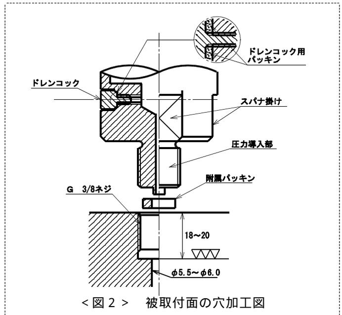
変換器内部に空気が残っていると測定誤差が生じる原因になりますので、予め空気抜きのために被測定流体を内部に導入しておきます。空気抜きはドレンコックを外した状態で被測定流体側の圧力を徐々に上げて行い、ドレンコックのネジ穴から空気と被測定流体が出てくるのを確認します。その際、圧力が高いと被測定流体が噴き出て非常に危険ですので最初は出来るだけ低い圧力にして操作をして下さい。実際には完全に空気が抜けるまで数回この操作を繰り返します。
